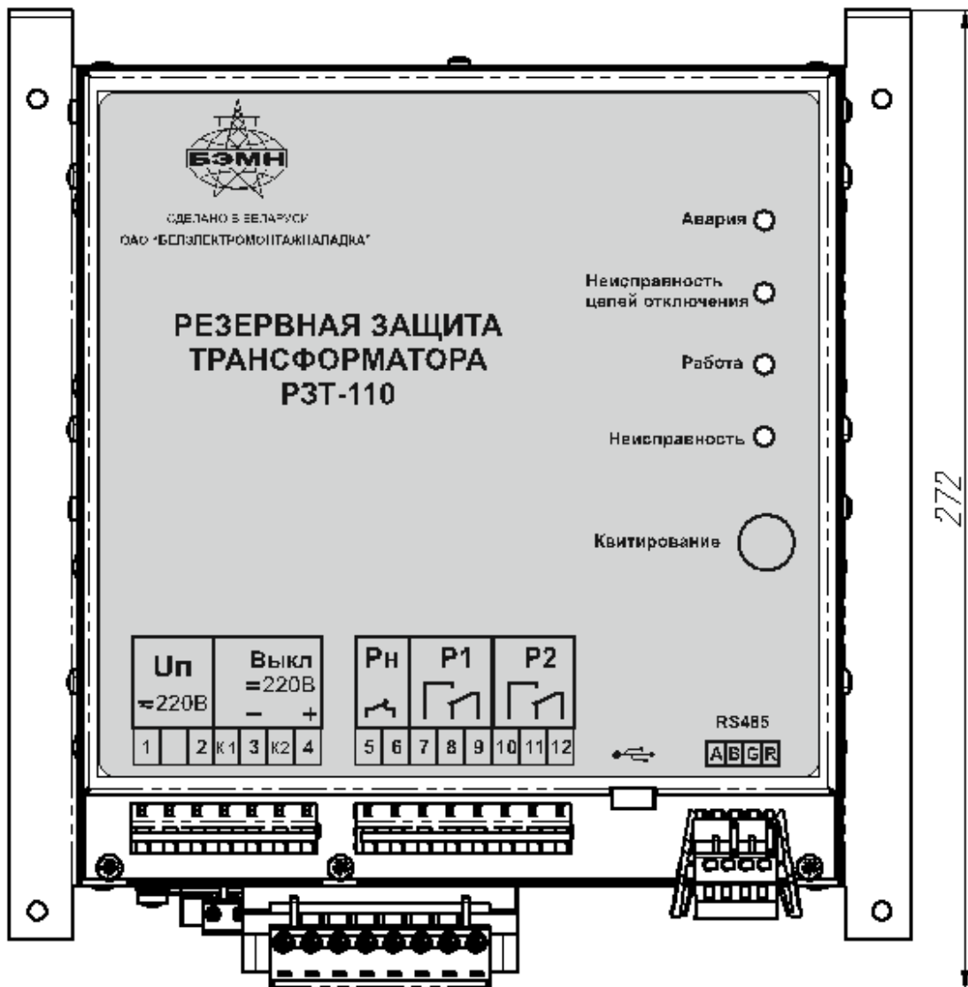
Рисунок А.2 – Габаритные размеры РЗТ-110 (с дискретами)
