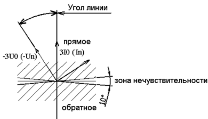
Рисунок 6.22 – Зона срабатывания направленной токовой защиты I^* (режим 3I_0 для всех видов защит, I_n )
