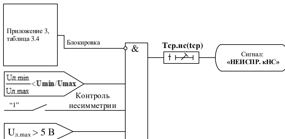
Рисунок 5.15 – Логическая схема алгоритма контроля несимметрии линейных напряжений
