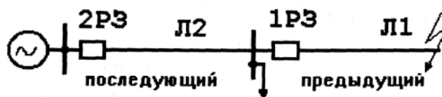
Рисунок 11.1 – Расчётная схема для выбора уставок релейной защиты (РЗ)
