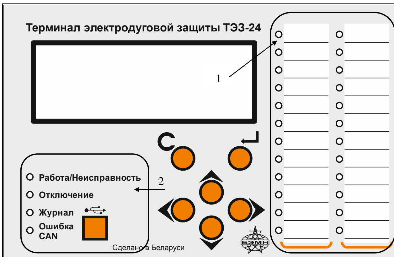
1 – индикаторы состояний МДО-1; 2 – индикаторы работы ТЭЗ-24
