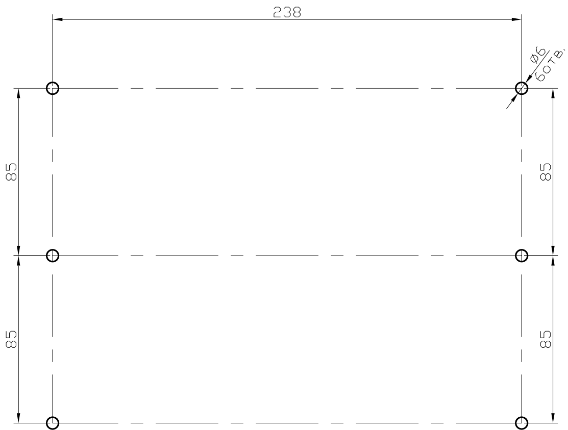
Размеры монтажных отверстий под установку РЗТ-110
