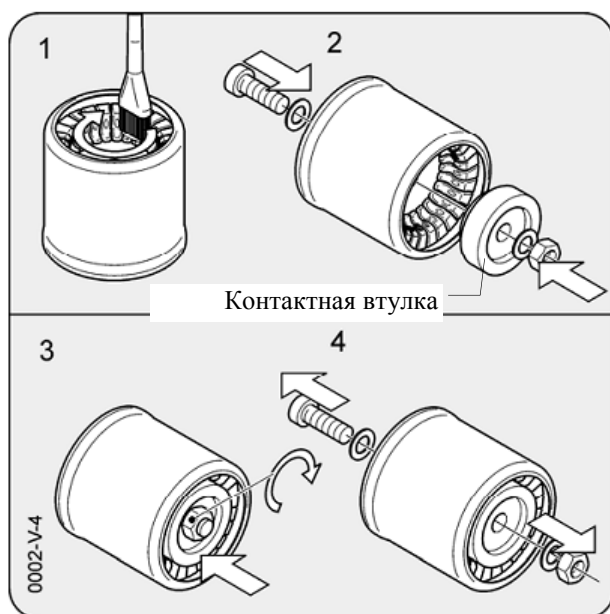
Рис. 25 – Подготовка контактной системы «тюльпан».
