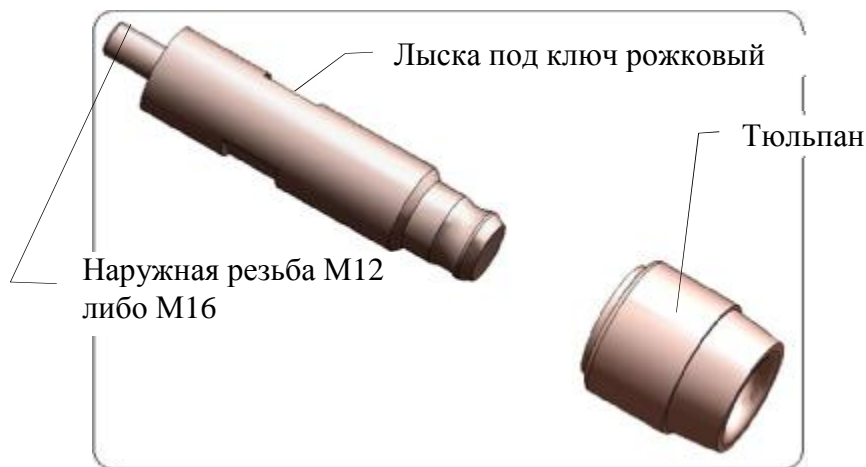
Рис. 33 – Медный цилиндрический токопровод с контактной системой (на токи до 1600А включительно).
