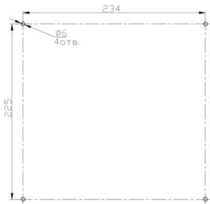
Рисунок Б.2 - Размеры монтажных отверстий под установку РЗТ-110
