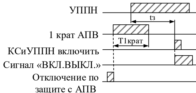
Рисунок 6.35а – Временные диаграмма работы логики УППН для ПО 1.14 – 1.16
