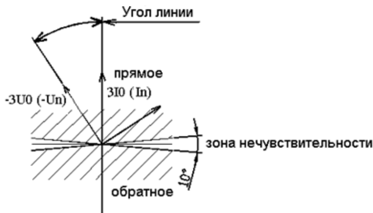
Рисунок 6.13 – Зона срабатывания направленной токовой защиты I^* (режимы 3I_0 , I_n )
