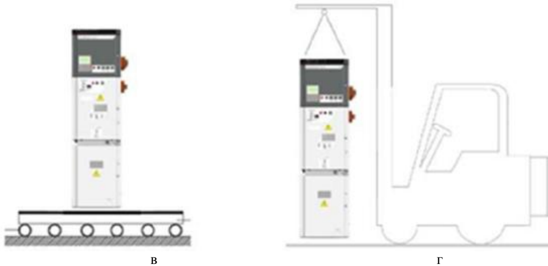
Рис. 16 Способы перемещения шкафов КРУ на транспортном поддоне а - вилочным автопогрузчиком; б - ручной подъемной тележкой; в - на валках; г - подъемными механизмами Транспортирование шкафов КРУ без транспортного поддона допускается только подъемными механизмами с зацепом строп через петли-проушины. Схема строповки представлена на рис. 17.
