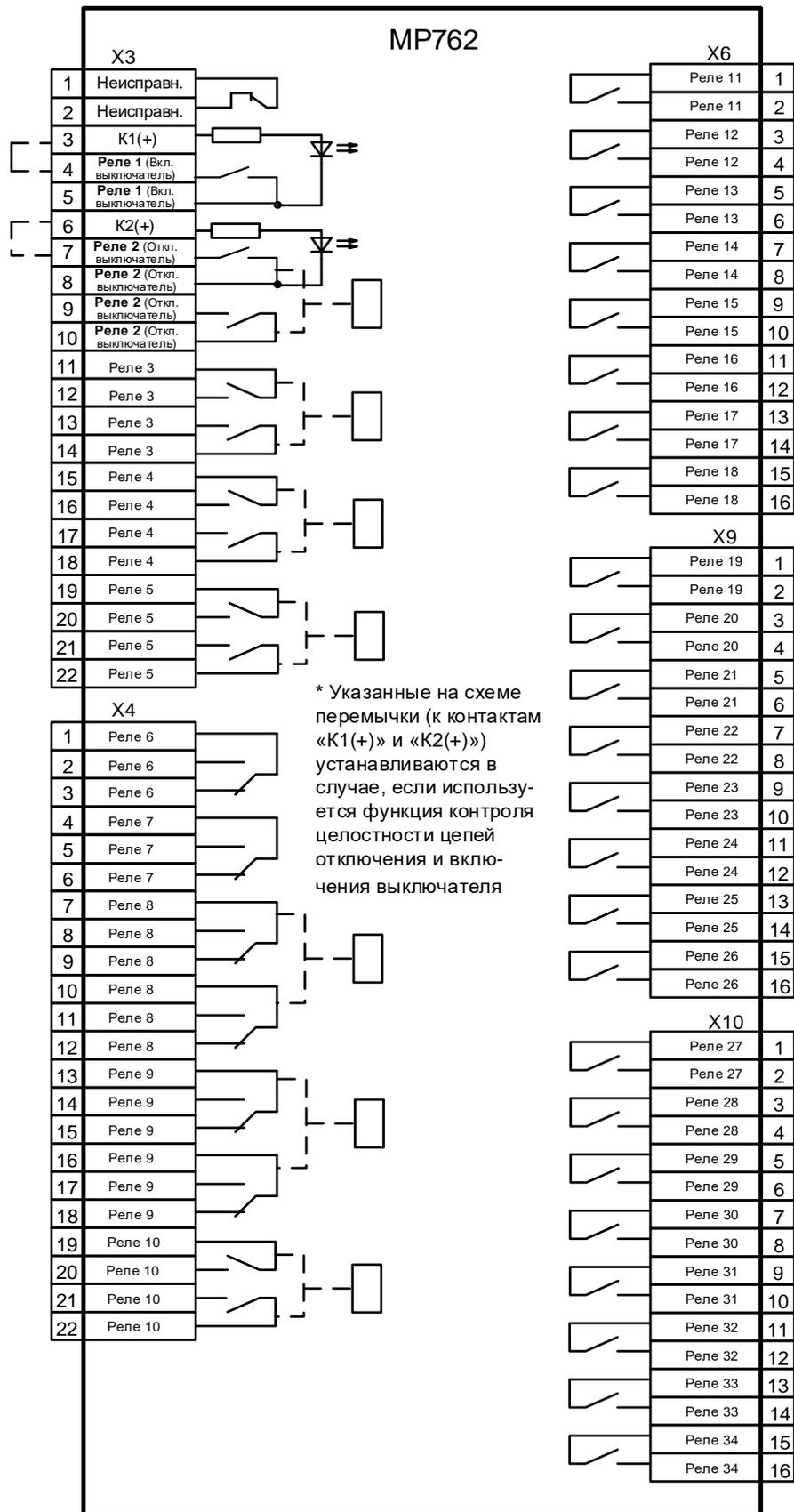
Рисунок А.6 – Схема подключения релейных выходов MP762
