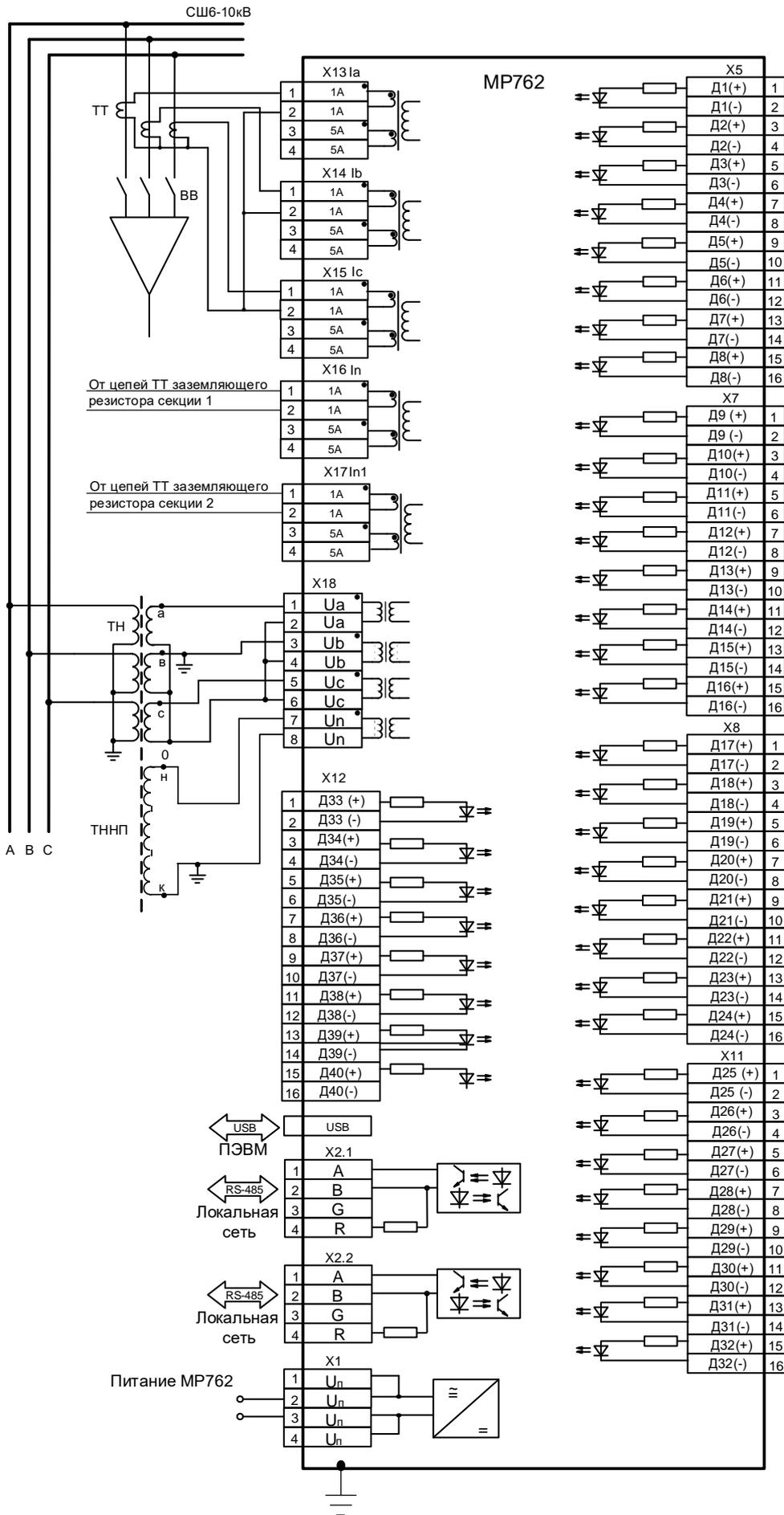
Рисунок А.4 – Схема подключения с тремя трансформаторами тока для MP762 (реализация защиты секционного выключателя в сети с заземляющими резисторами)
