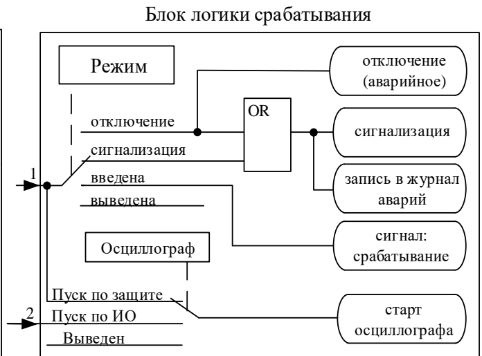
Рисунок 6.16 – Логическая схема ступеней токовой защиты I* (блоки)
